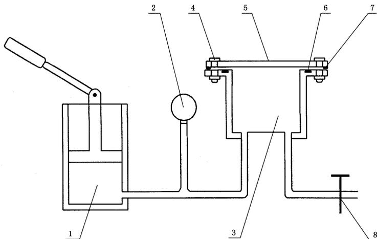
1—水泵;2—压力表;3—试模主体;4—紧固螺栓;5—试模盖板;6—试样槽;
