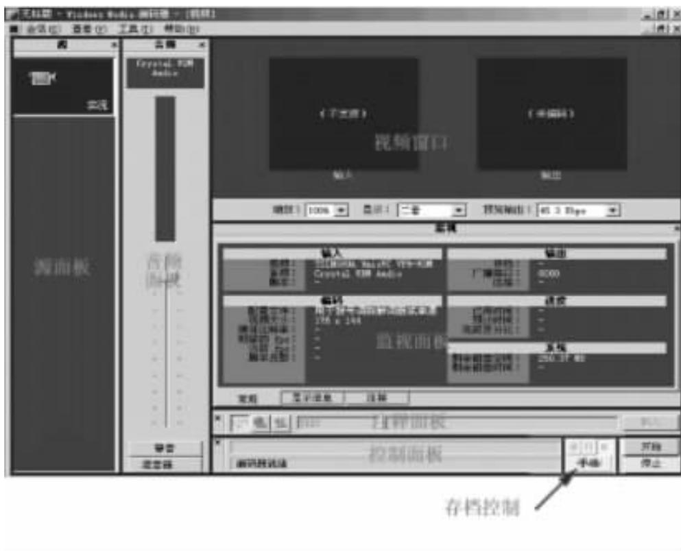
图 3.3 Windows Media Encoder 7 的面板构成
