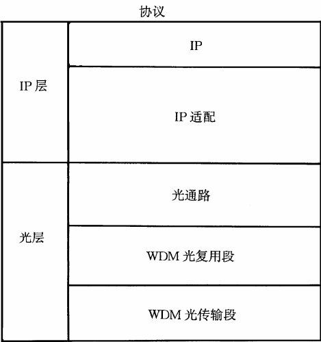
图 10.29 IP Over WDM 的协议模型
