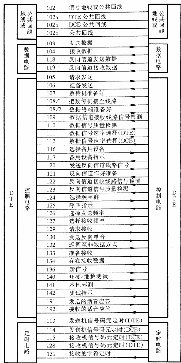
图 6.13 V.24（100 系列）接口电路的连接
