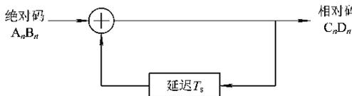
图 4-26 模 4 加的原理框图
