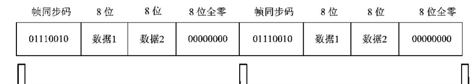
图 6-22 输出信号的帧结构
