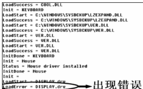
图 5.4 Bootlog 文件记录下了问题的根源
