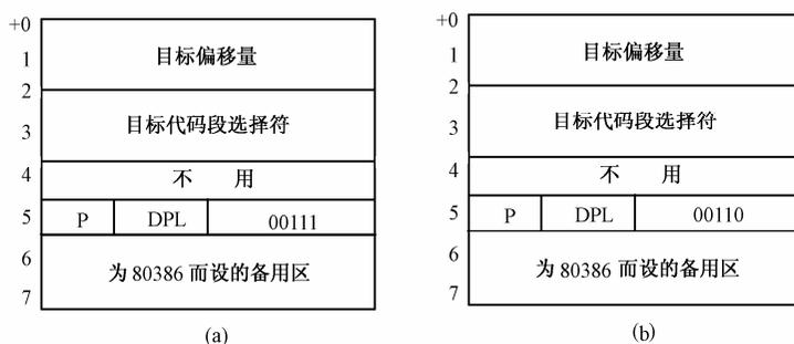
图 4-20 80286 的自陷门和中断门格式
