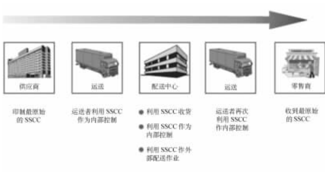
图 4-5-3 整个上、中、下游运送过程所有的相关运送实体扫描 SSCC
