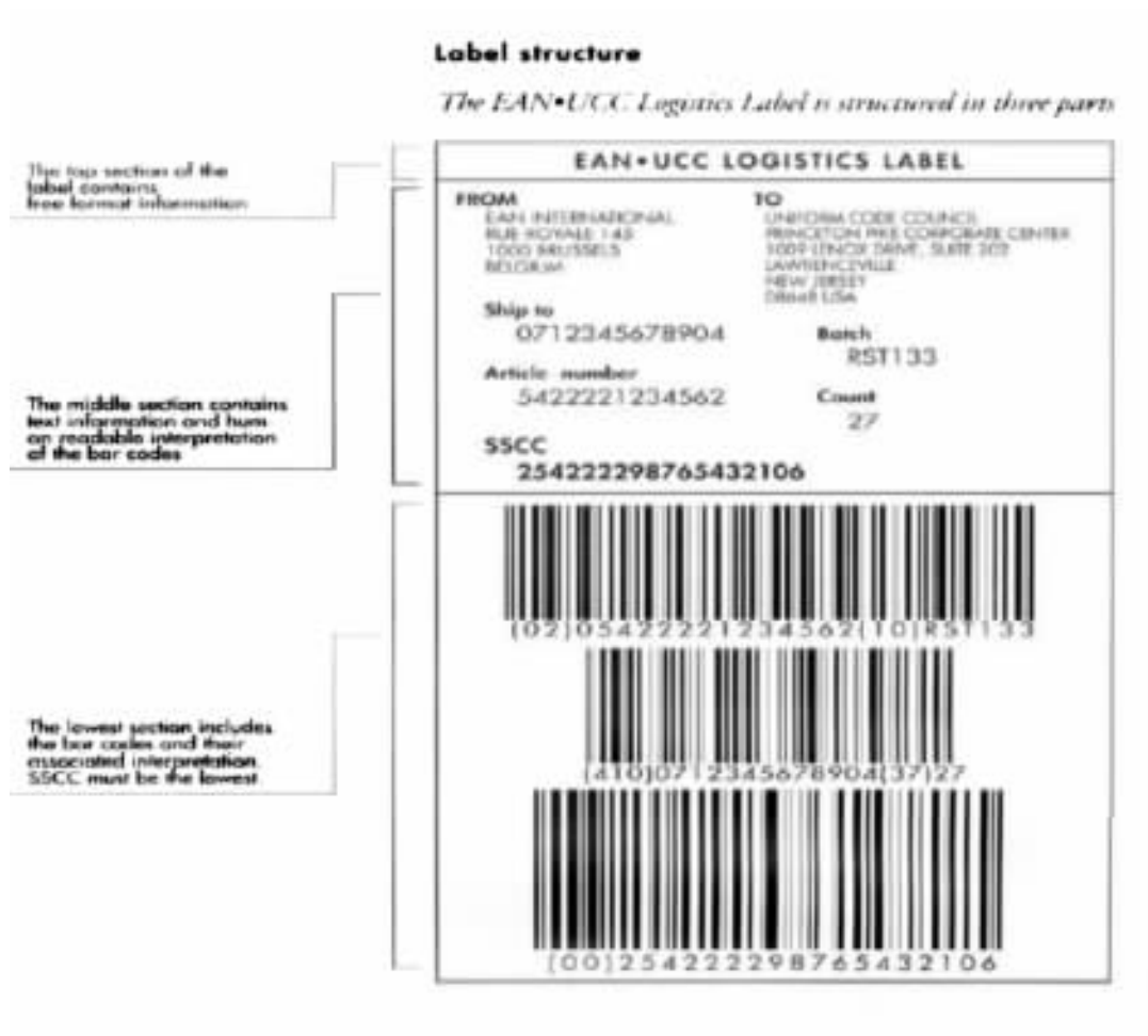
图 4-5-4 Kuhne & Nagel 公司采用 EAN · UCC-128 标准标签
