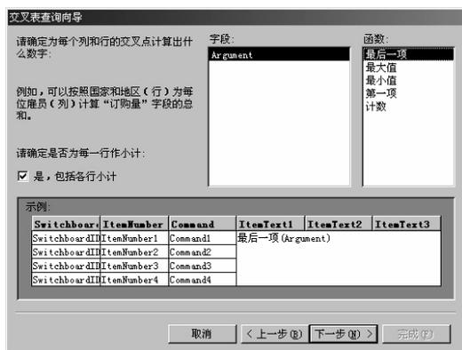
图 3-13 确定在每个行和列的交叉点上计算的数字
