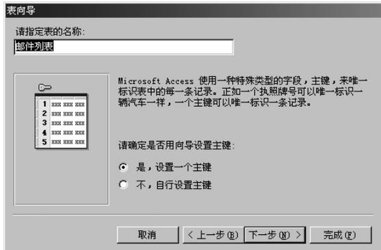
图 2-11 在“表向导”对话框中命名表和设置主关键字
