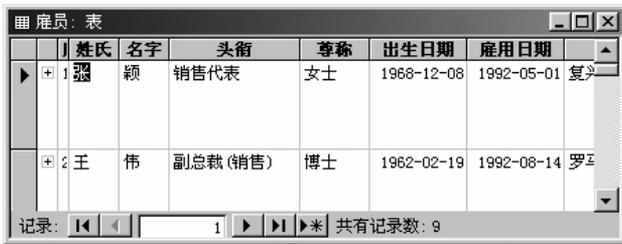
图4-2 将鼠标指针指向两个记录选定器之间来改变行高
