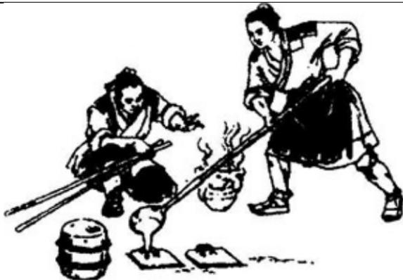
图二: 铸造铁农具示意图
