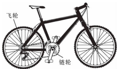
图 7-2 链轮最大、飞轮最小
