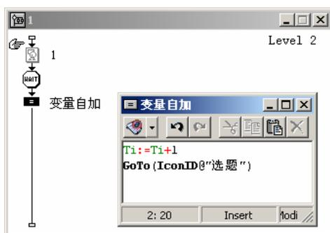
图 42.4 设置程序跳转
