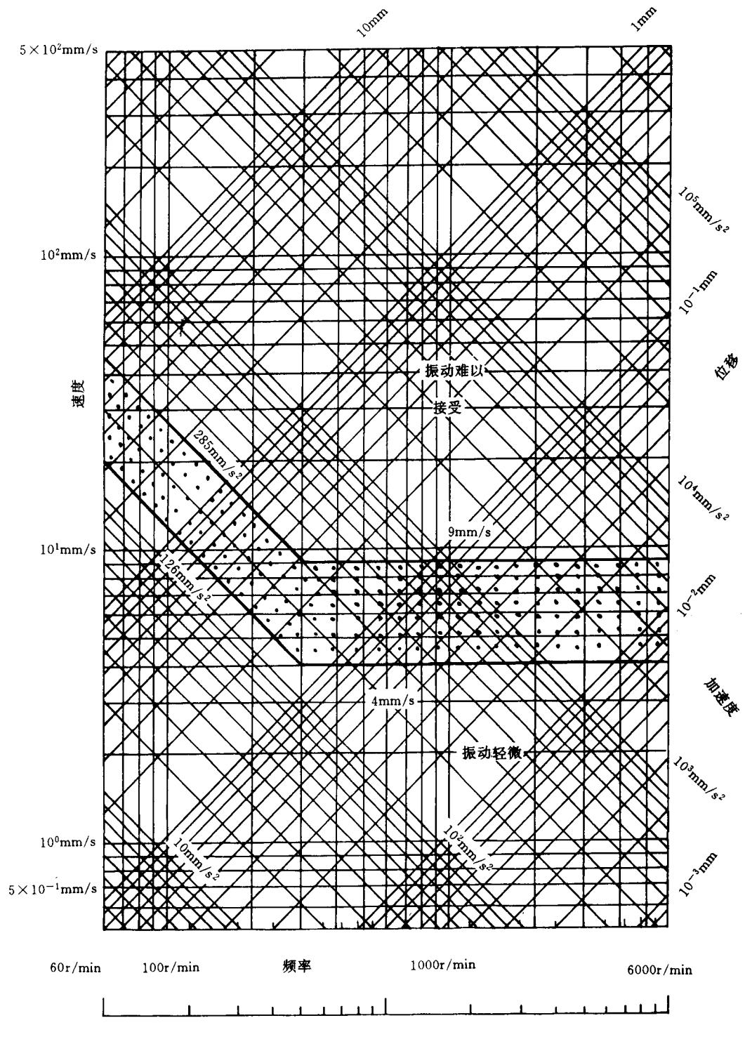
图 1 商船垂向和水平振动评价基准(峰值)<sup>1)</sup>
