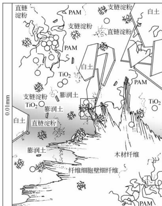
图 3-3 在 0.01mm 的尺度内观察到的流浆箱内的纸料
