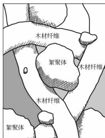
图 7-17 补丁-桥联机理对细小纤维的助留作用示意图
