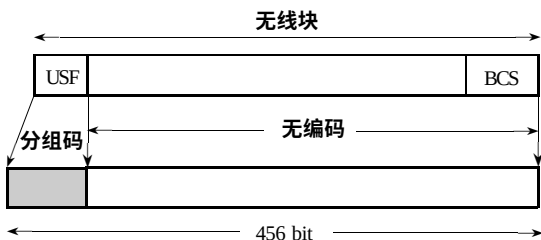
图 7-8 CS-4 编码方案中的无线块结构
