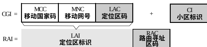
图 6-5 全球小区定位标识和路由寻址标识的比较
