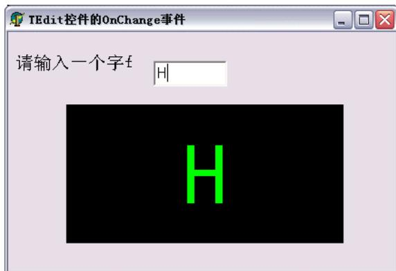
图 5.22 TEdit 控件的 OnChange 事件示例
