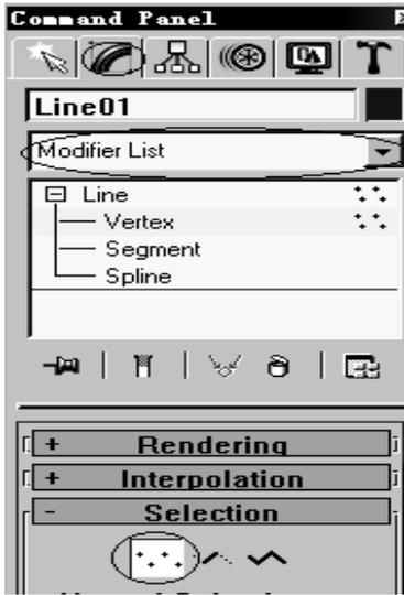
图 3-32 曲线的修改面板
