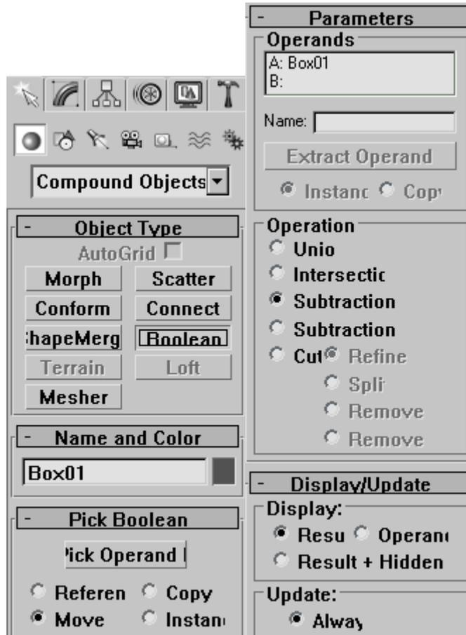
图 4-2 逻辑运算的控制面板
