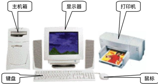
图 1.5 微型计算机系统配置
