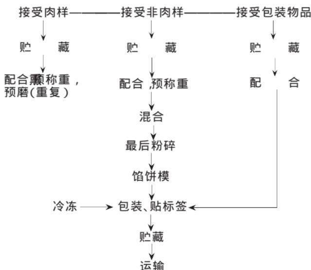
图 2-3 生兔肉馅饼生产的工艺流程图
