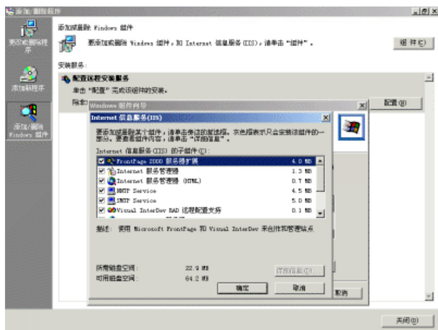
图 20.5 安装 IIS 的各项组件窗口
