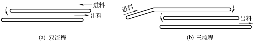
图 缘圆摇多流程一段带式流态化速冻装置传送带的排列
