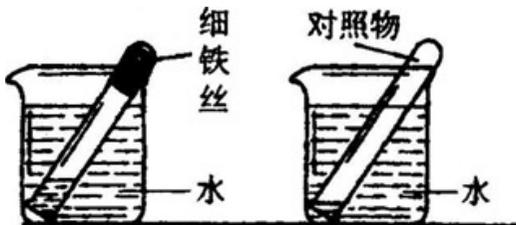
(2)取一段光亮无锈的细铁丝,绕成螺旋状,放入一支洁净的试管底部,将试管倒放在一个盛有水的烧杯里(铁丝稳定而不下落),再装配一支没有铁丝的试管做对照实验(如上图)。
