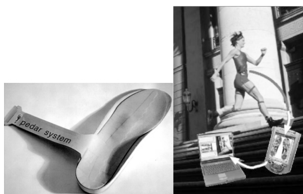
图 2-26 测力鞋垫及数据传递示意图
