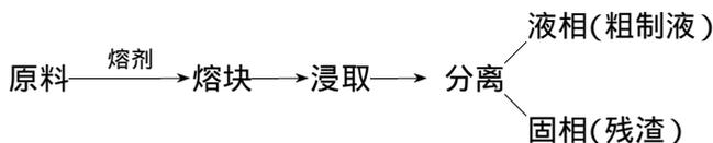
据选择的熔剂不同,又可分为酸熔、碱熔两种。
