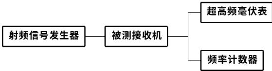
图 11 相邻波道选择性单信号测量法测量方框图
