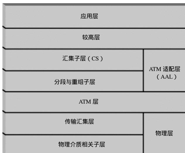
图 6.7 B-ISDN 协议栈
