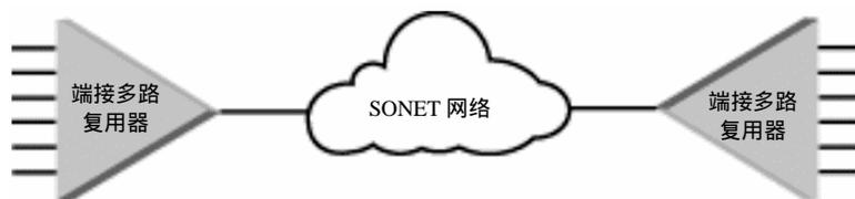
图 3.26 SONET 端接多路复用器 (TMUX)
