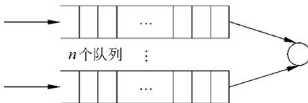
图 12.3.2 多队列 M/M/n 模型示意图
