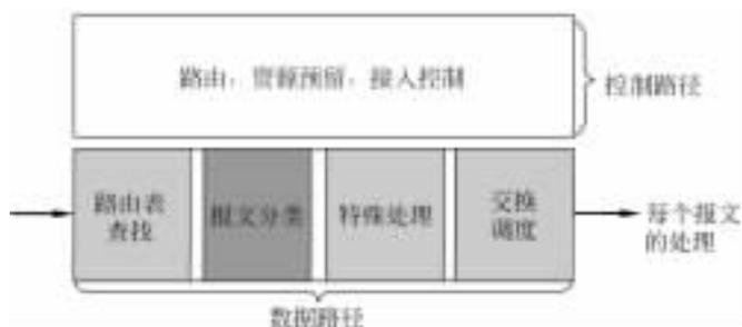
图 7.1.2 流识别路由器的基本结构组成
