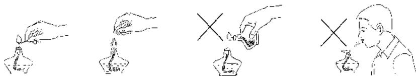
图 0-3 点燃和熄灭酒精灯的正确方法和错误方法
